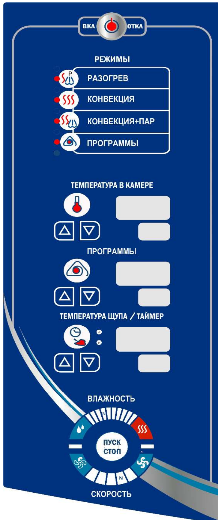
Рис. 2. Внешний вид пленочной клавиатуры
