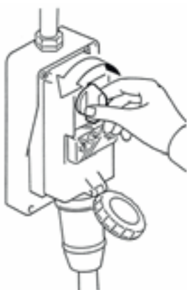
Рис. 6.2.1. - Блок управления электропитанием в положение ВЫКЛ (O - OFF)
