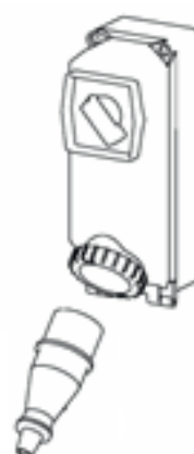
Рис. 6.2.2. – Блок управления электропитанием выключен
